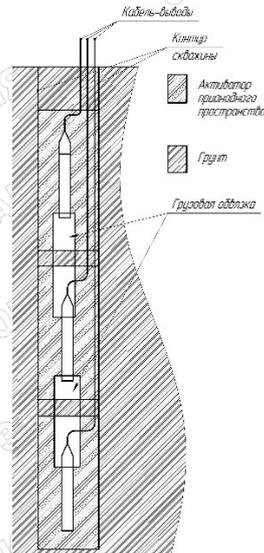
Установка в скважину АЗЖК-РА-Г с грузовой обвязкой без магистрального кабеля
