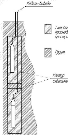
Установка в скважину АЗЖК-РА-Г без грузовой обвязки и без магистрального кабеля
