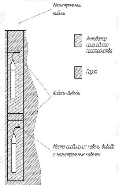
Установка АЗЖК-РА-Г-МК без грузовой обвязки с магистральным кабелем
