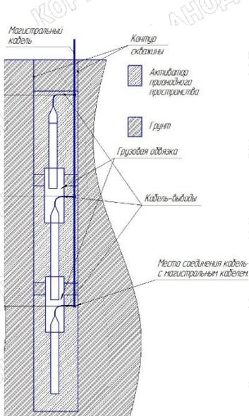
Установка в скважину АЗЖК-РА-Г-МК с грузовой обвязкой и магистральным кабелем
